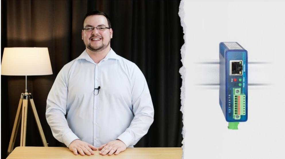
Mit dem Web-IO Analog greifen Sie über Ethernet auf analoge Strom- und Spannungssignale zu. Modellabhängig erfassen, überwachen und setzen die Geräte 0/4-20mA- oder 0-10V-Einheitssignale nach DIN IEC 60381-1 und -2.
