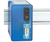
Com-Server Highspeed 100BaseLX Monomode-Glasfaser mit SC- Anschluss
