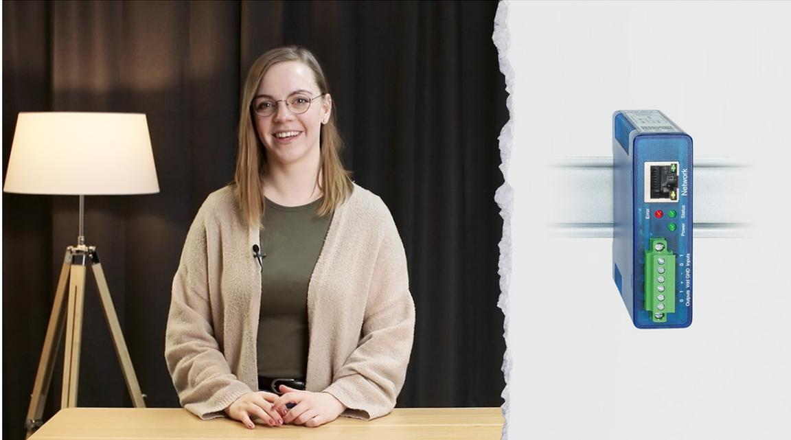
Das Web-IO Digital bietet Zugriff auf digitale Schaltsignale bis 30V über das Netzwerk.
