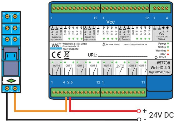
Das Web-IO kann wahlweise aus der gleiche 24V Stromversorgung oder über PoE (Power over Ethernet) versorgt werden.
