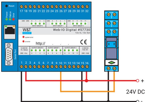
Die Geräteversorgung Vcc (Klemmen 1, 2) und die Outputversorgung Vdd (Klemmen 15, 16) können aus der gleichen 24V Stromversorgung gespeist werden.
