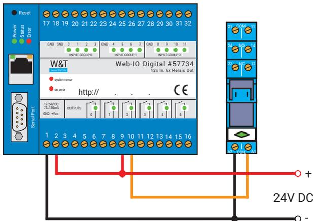
Die Geräteversorgung Vcc (Klemmen 1, 2) und die Relaisschaltspannung können aus der gleichen 24V Stromversorgung gespeist werden.
