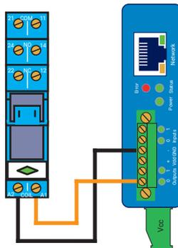
Das Web-IO kann wahlweise über die Klemme Vcc oder PoE (Power over Ethernet) versorgt werden. In jedem Fall muss die Interne 24V IO-Versorgung aktiviert werden (Menü Grundeinstellungen >> Inputs/Outputs)
