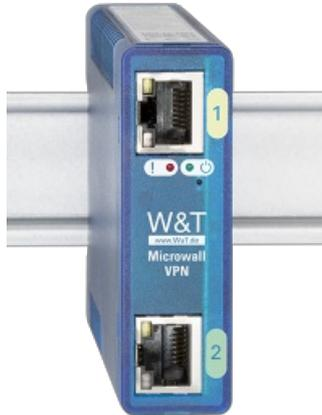
Ob Werkzeugmaschine, Röntgengerät oder Aufzugsteuerung: Die Microwall trennt schützenswerte Systeme vom umgebenden Netzwerk. Sie steuert, überwacht und protokolliert die Kommunikation mit dieser sicheren Insel anhand grundlegender Regeln.
