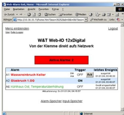
Este aparato ofrece la posibilidad de utilizar sensores con contactos de conexión como iniciadores para sucesos de alarma. La alarma puede activarse al aparecer sucesos individuales o al alcanzar una cifra definida de impulsos en la entrada respectiva. Se puede hacer una notificación localmente a través de procesos de conexión de las salidas digitales y enviarse en forma de E-Mail, SNMP Trap, cliente TCP y UDP, Syslog Messages y FTP a través de una red basada en TCP/IP.
