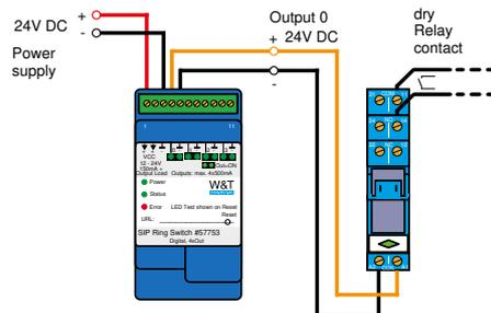
La tensione di alimentazione viene collegata al morsetto 1 e il GND al morsetto 3.
