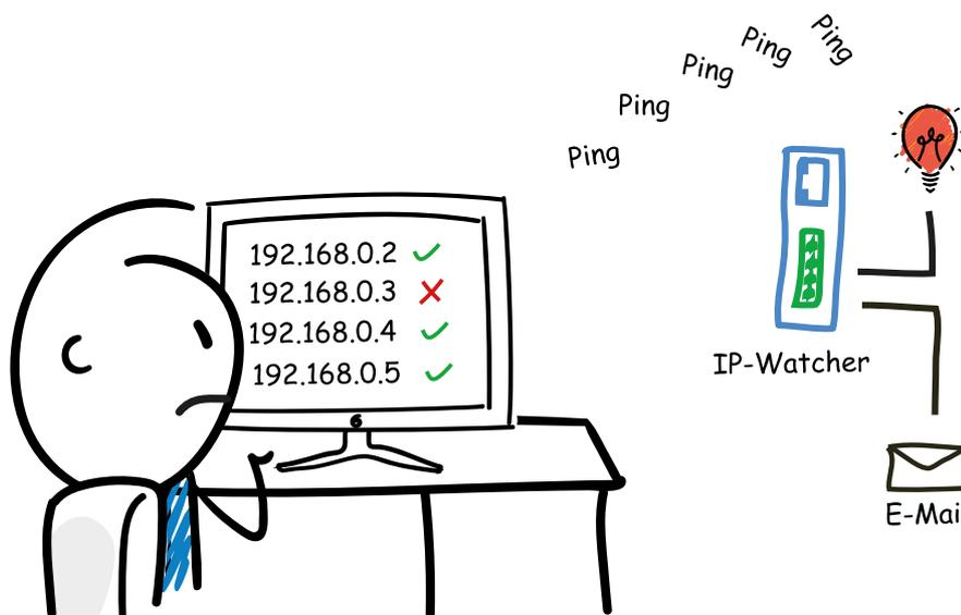
Con el IP-Watcher se pueden supervisar hasta 100 nodos de red o direcciones IP.
