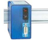
Com-Server Highspeed 100BaseLX Monomode-Glasfaser mit SC- Anschluss
